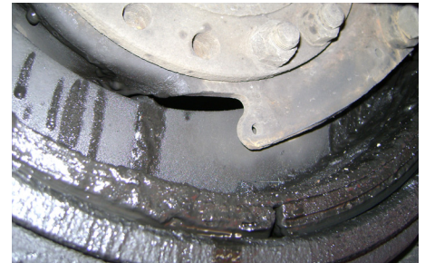
Garniture contaminée. M.H.S., Partie II, a.(5)(c)vi / 393.47(a)-U.S.
