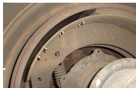
Bloc de garniture manquant. M.H.S., Partie II, a.(5)(c)ii / 393.47(a)-U.S.
