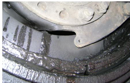
Garniture contaminée. M.H.S., Partie II, a.(5)(c)vi / 393.47(a)-U.S.
