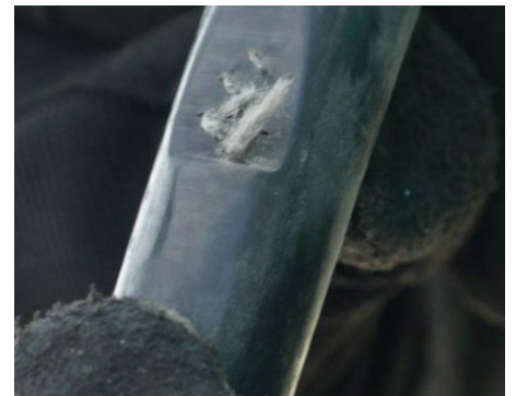
La manguera de freno raída hasta la capa de refuerzo es una infracción de fuera de servicio.
