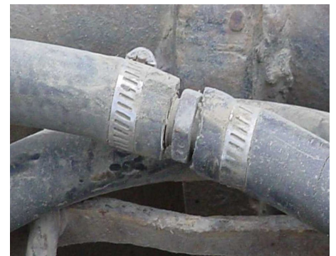
Esta reparación incorrecta de la manguera de los frenos es una infracción de fuera de servicio.
