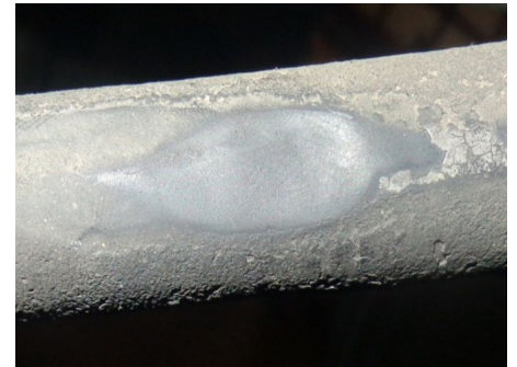
La reducción en el diámetro de la manguera de los frenos (p. ej., debido al raimiento activo) es una infracción.
