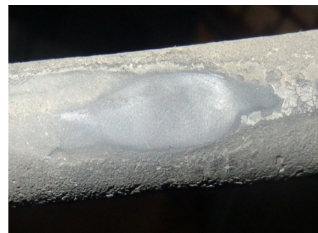
Une réduction du diamètre du flexible de frein (par exemple en raison d'un frottement actif) constitue une infraction.
