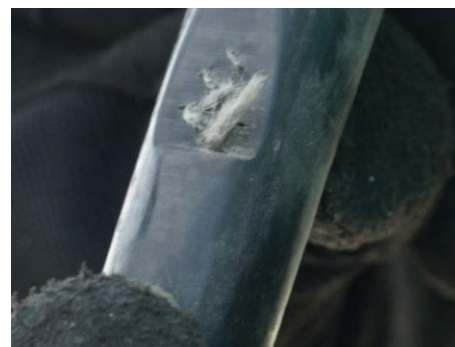
Un flexible de frein dont le pli de renforcement est usé par frottement constitue une infraction entraînant une mise hors service.
