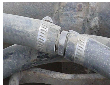
Cette réparation inappropriée du flexible de frein constitue une infraction entraînant une mise hors service.
