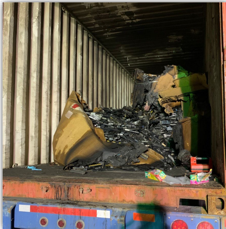
Consecuencias de un incendio en un envío de baterías de litio no declaradas
