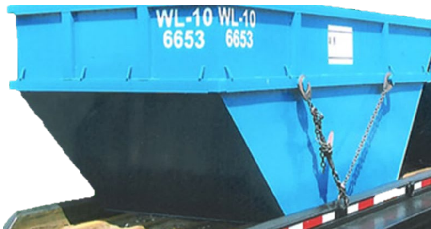
Ejemplo: Amarres asegurados a los lados en ambos lados
