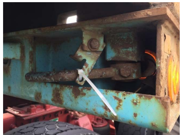
Figure 4 : Utilisation d'attaches additionnelles de type "Tie-Wrap"
