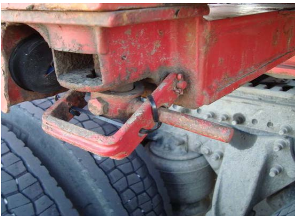
Figure 4 : Utilisation d'attaches additionnelles de type "Tie-Wrap"
