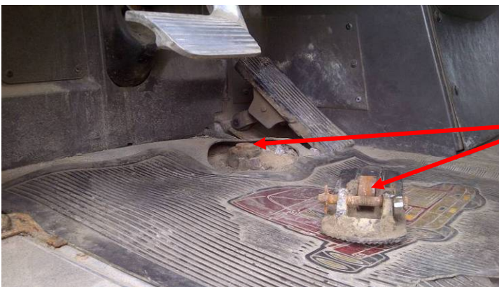
Figure 1 : Pédale de frein cassé montrant un dommage dû à la corrosion excessive.
